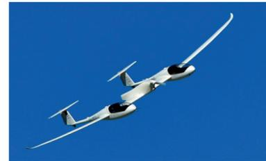
HY4 – erste viersitzige Passagierflugzeug, das ausschließlich mit einem Wasserstoff-Brennstoffzellen-Batteriesystem angetrieben wird (DLR)
