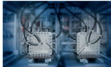
Polymerelektrolytmembran-basierte Stack-Kombination bei der Charakterisierung im Elektrolyseteststand (FZJ)
